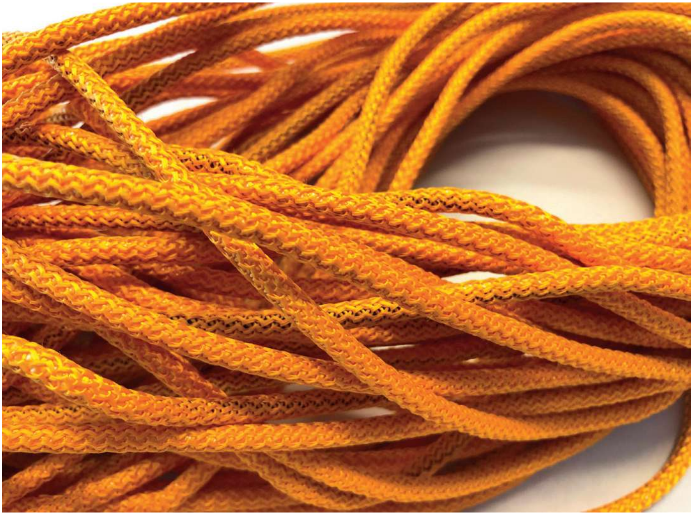
Restgarnner bliver genanvendt til vulstsnore, der anvendes til ophæng af kanalsystemer.
