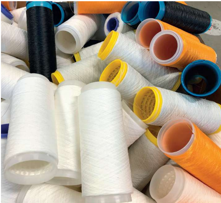
Plastrør fra garnleverandør genanvendes til hjørneprofil til loftpanel.
