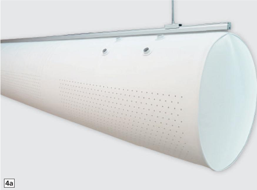
**4a** Ein textiler Luftkanal samt Montage-Zubehör. Solche Lösungen bieten ausgezeichnete akustische Eigenschaften (weiches Material). Es gibt keine Kondensationsprobleme: Das Material "atmet" und Polyester absorbiert unter 0,5 Prozent Feuchtigkeit. Es ist sehr leicht, so dass das Gewicht keinen Einfluss auf die Gebäude-Statik hat. (Quelle: KE Fibertec)
