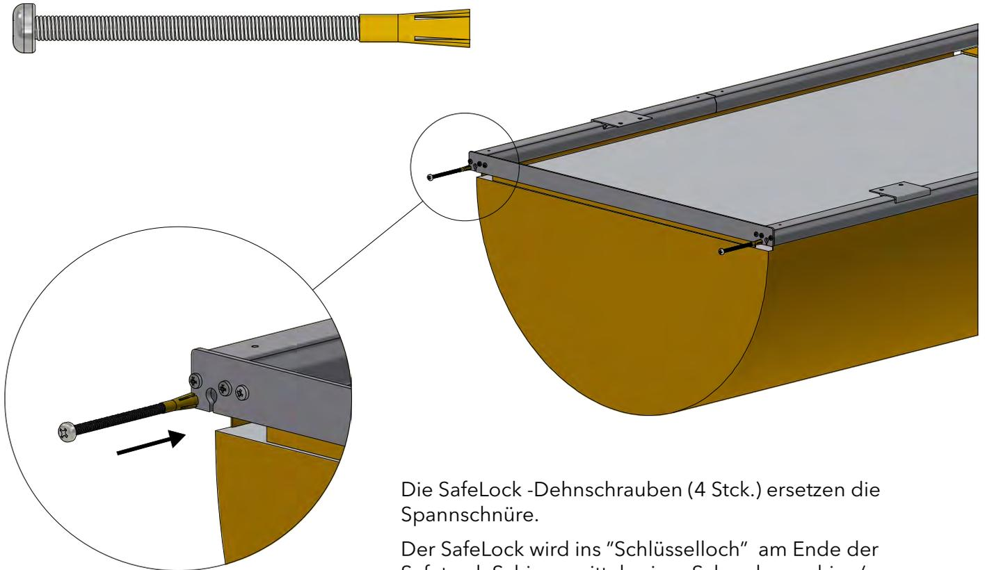
Die SafeLock -Dehnschrauben (4 Stck.) ersetzen die Spannschnüre.
