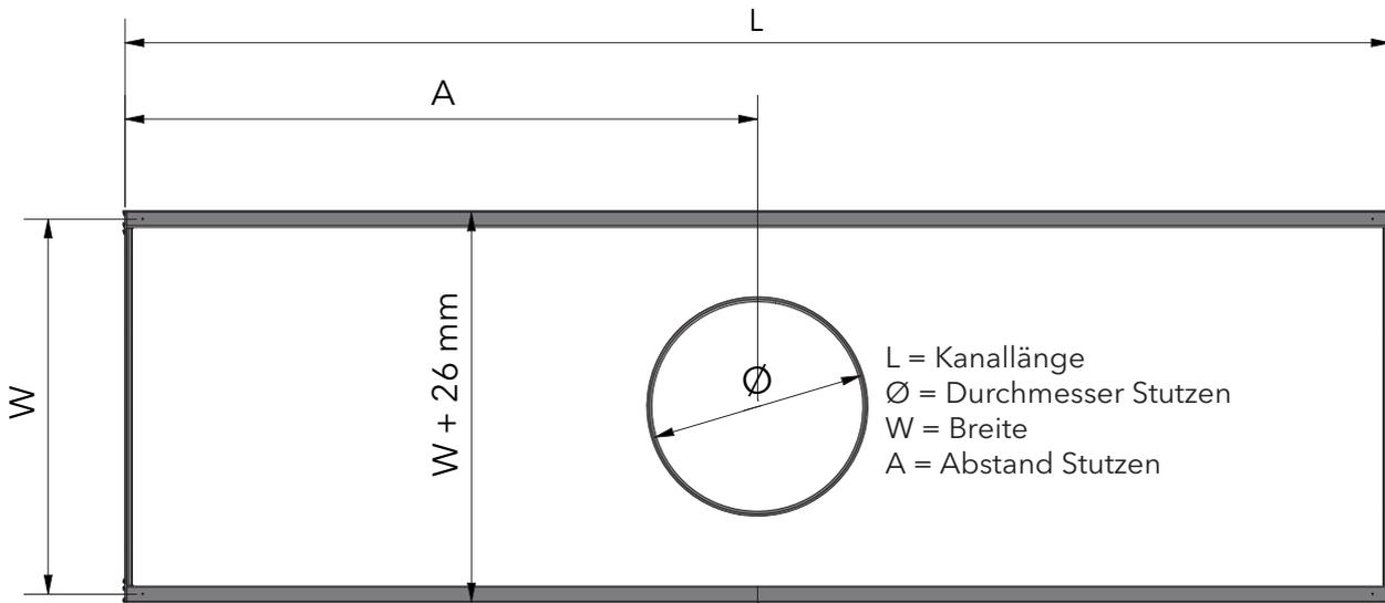
Maß A auf der Schiene markieren, sodass die Platzierung des Stützens nach Montage des Kanals deutlich hervorgeht.
