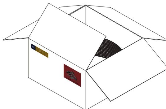
Bei Kanälen über Ø500 mm werden Ringe getrennt mitgeliefert (vorort einsetzen)
