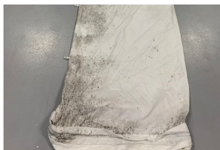
Tekstilkanal monteret i meget fugtigt miljø uden vedligehold.
