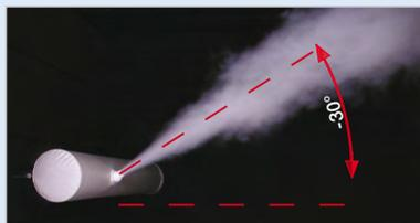
Die KE-DireJet Vario Düse kann manuell eingestellt werden, so dass die Hauptrichtung der Luftdüsen um bis zu -30° in Bezug auf die Mittellinie der Düse verändert werden kann. Dies kann besonders geeignet sein, wenn der Aufbau des Raumes nach der Installation des Systems geändert wird. Diese Düseneinstellung kann auch in Situationen verwendet werden, in denen eine große Kühllast im Raum zugeführt werden muss.
