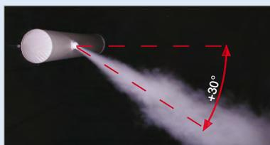
Durch die manuelle Einstellung kann auch die Hauptrichtung der Luftdüsen um bis zu +30° in Bezug auf die Mittellinie der Düse geändert werden. Wie oben erwähnt, kann dies besonders praktisch sein, wenn der Aufbau des Raumes nach der Installation des Systems geändert wird. Diese Düse kann einen großen Vorteil bieten, wenn sie in Situationen verwendet wird, in denen eine große Heizlast für den Raum geliefert werden muss.
